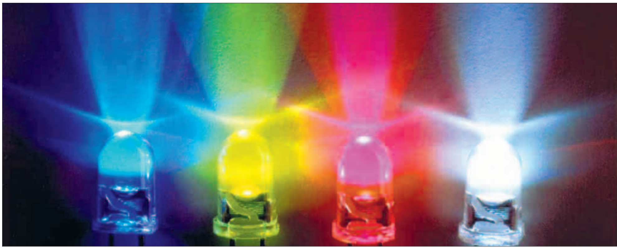
Das Spektrum der Farben, die LEDs aussenden, wird durch Variation der Licht emittierenden Halbleiter zusehends erweitert. Jetzt kommt zu Blau, Gelb und Rot (sowie Weiß als Mischfarbe) noch unsichtbares UV dazu
