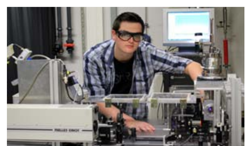
Messplatz für die UV-Photolumineszenzspektroskopie. Die AG hält momentan den Weltrekord für die kürzeste Emissionswellenlänge bei AlGaIn Quantenfilm-Lasern.
